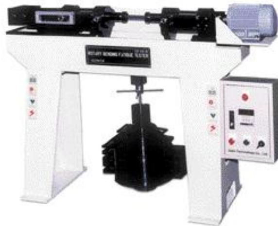
회전 굴곡 피로 시험기 (Rotary Bending Fatigue Testing Machine)
